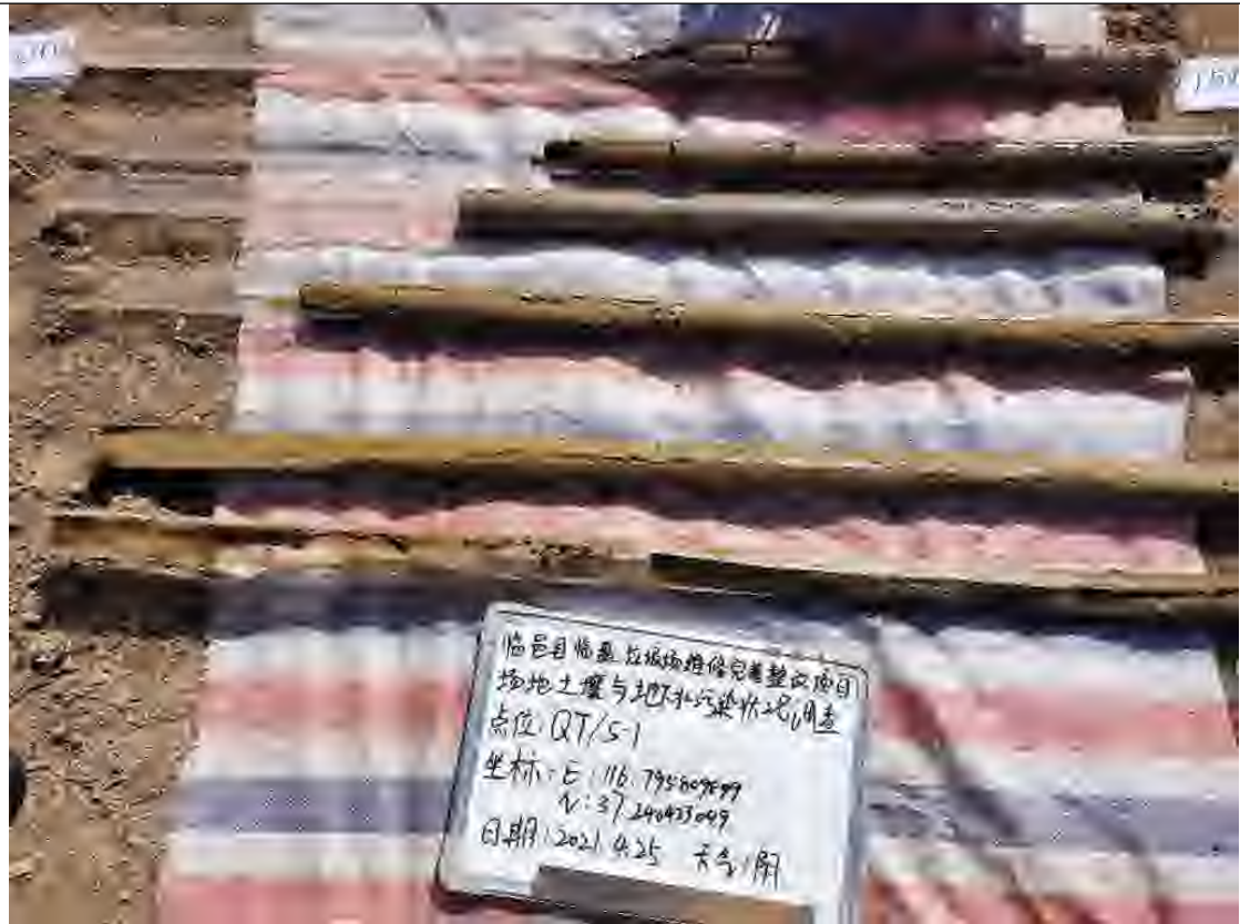
QT/S-1 孔现场土样采集照片
