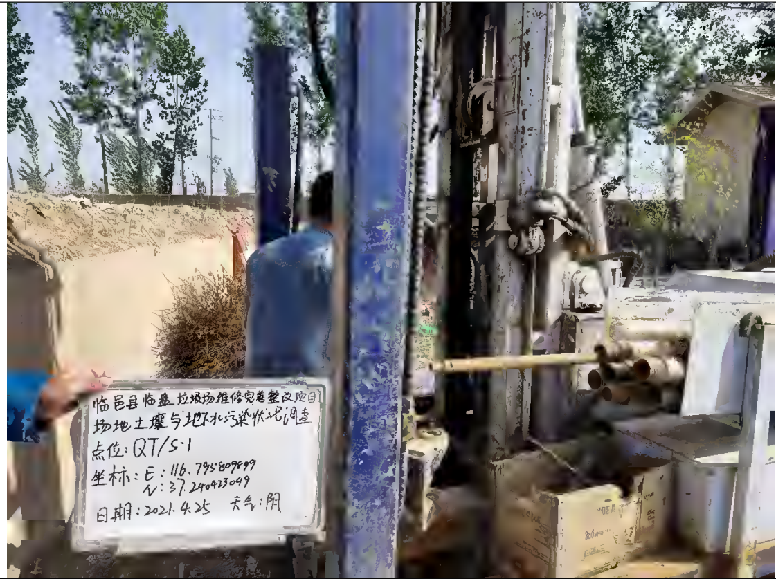
QT/S-1 孔现场土样采集照片
